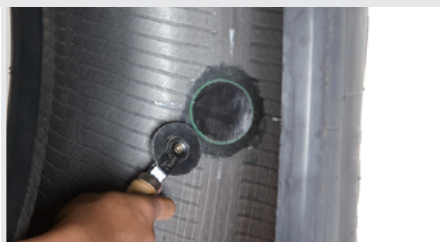
15 貼り付けたパッチをローラーなどで圧着します。※パッチ中央部から外側に向け空気を抜くイメージで圧着してください。
