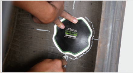
9 タイヤパッチMBの中心がキズ穴にくるようにセットし、パッチより少し大きめにクレヨンなどで線取りします。
