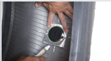
9 タイヤパッチMUの中心がキズ穴にくるようにセットし、パッチより少し大きめにクレヨンなどで線取りします。
