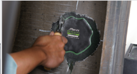
15 貼り付けたパッチをローラーなどで圧着します。※パッチ中央部から外側に向け空気を抜くイメージで圧着してください。
