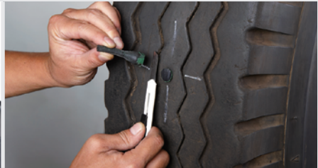
16 タイヤ外側に出ているステムを2~3mm程度残り切り取り、タイヤ内側のオーバーバフ部をシーライナーで補修します。これで作業は終了です。
