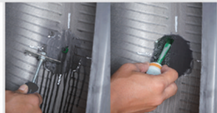
10~13 内面修理手順 タイヤパッチMR&マルニシステム(23ページ)と同じように進めます。
