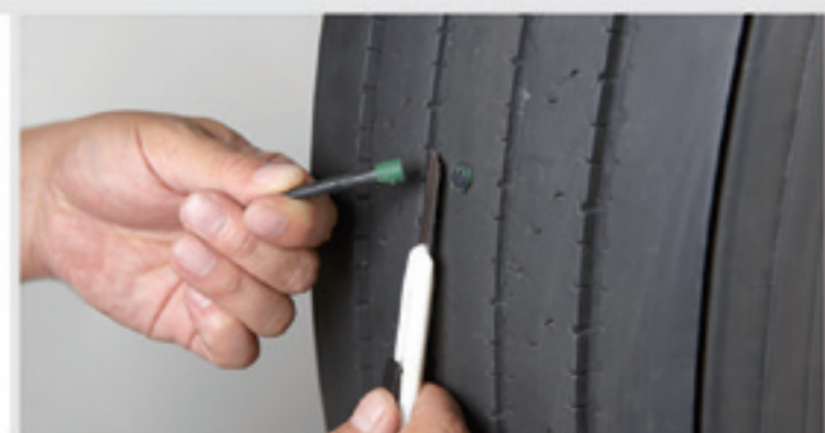
16 タイヤ外側に出ているステムを2~3mm程度残し切り取り、タイヤ内側のオーバーバフ部をシーライナーで補修します。これで作業は終了です。
