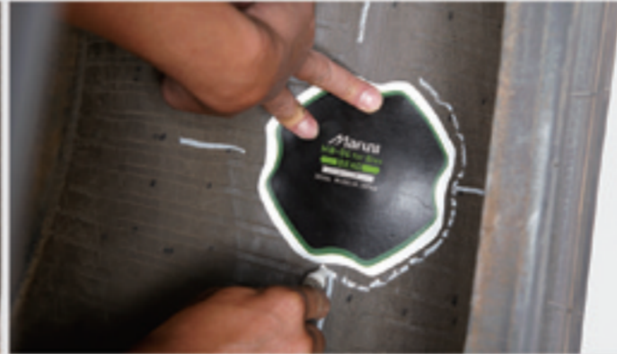
9 タイヤパッチMBの中心がキズ穴にくるようにセットし、パッチより少し大きめにクレヨンなどで縁取ります。
