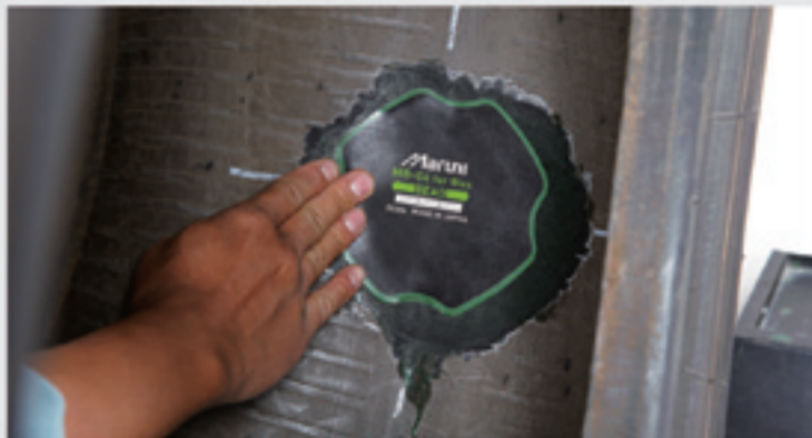
14 パッチ表面の保護フィルムを剥がし、パッチの中心にキズ穴を合わせ貼りつけます。※保護フィルムを剥がす際にパッチの緑色の部分(接着層)を手で触れないように注意してください。
