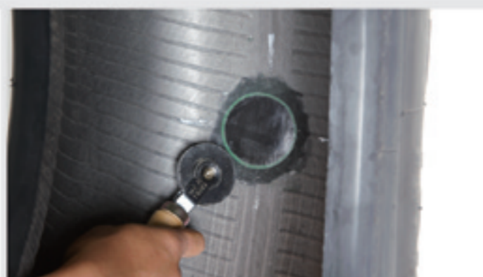
15 貼り付けたパッチをローラーなどで圧着します。※パッチ中央部から外側に向け空気を抜くイメージで圧着してください。
